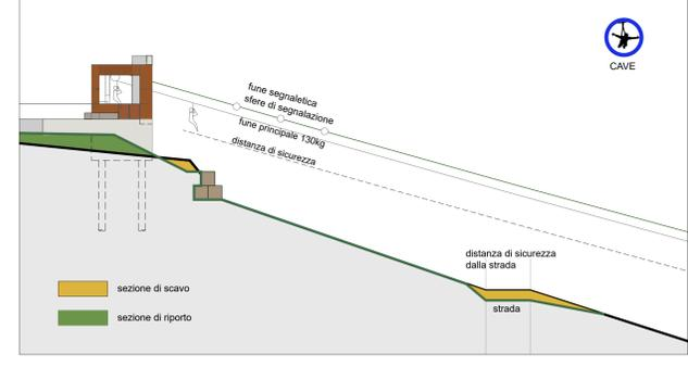
**Schematizzazione del sistema di ARRIVO** scala 1:200
